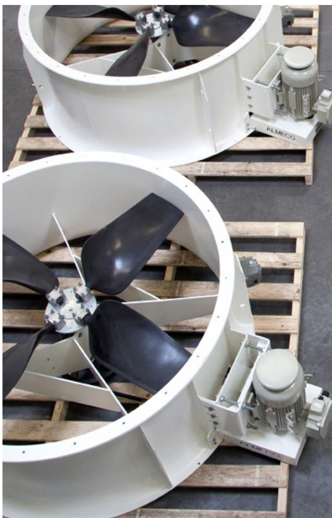
Type : AVREX 2000/4/4-(7)/FRP/R/8,4° Motor : 11kW 3x400V 50Hz Eexde IIB T4 Atex : II 3G c II A T2 / API : 661 Q= 87500 m 3 /h, Hstat= 170 Pa at 40°C
