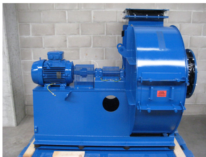
Type : ExCV900-104/2/4P/RD0 Motor : 11kW 3x400V 50Hz EexnA II T3 Atex : II 3G c II B T3 Q= 10.000 m 3 /h, Htot= 2.450 Pa at 90°C
