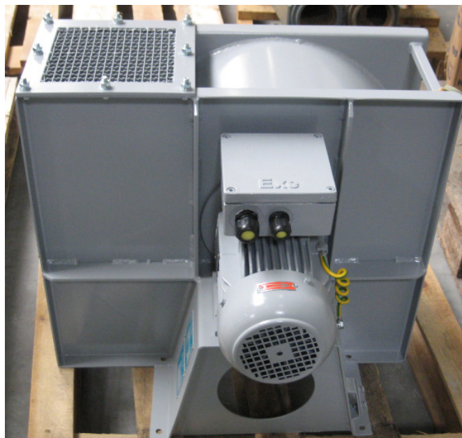
Type : EX CV-355/4-104 Motor : 1.1kW 3x400V 50Hz Eexde IIC T4 Atex : II 2G c II BT3 Q= 1.500 m 3 /h, Hstat= 1.300 Pa at 20°C
