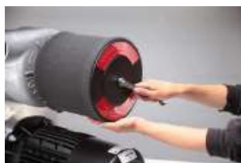
Stap 1: Verwijder het voorfilterelement door de beveiligingsmoer en -sluitring los te maken. Gebruik een 17 mm AF-sleutel.
